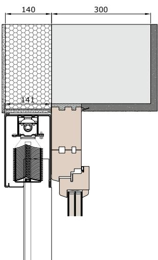
S napojením na zateplovací systém a zdvojeným okenním rámu. Raff S kryt.
