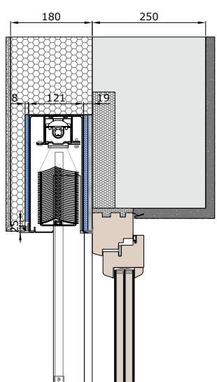
S napojením na systém zateplení a zateplením překladu. Raff S WDVS.
