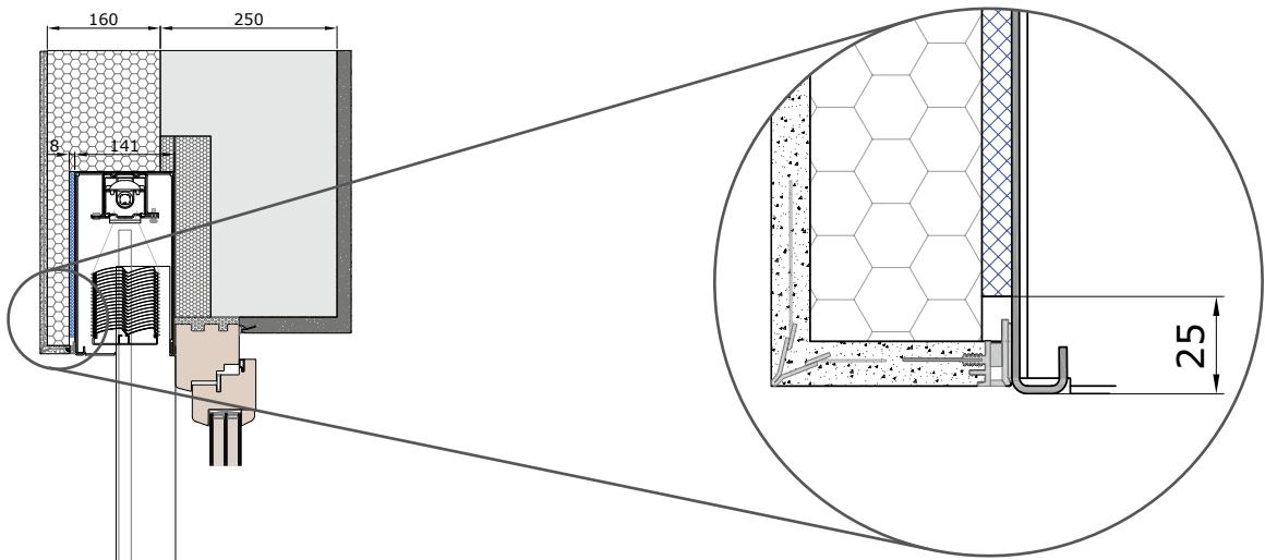
S napojením na zateplovací systém.
